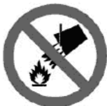
НЕ ГАСИ ВОДОМ
